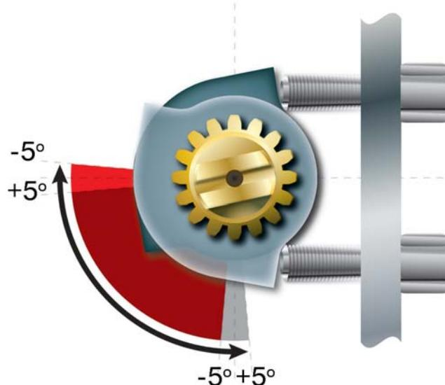
Для регулирования хода привода в более широких пределах (+/-15°) необходима установка внешних ограничителей хода.
