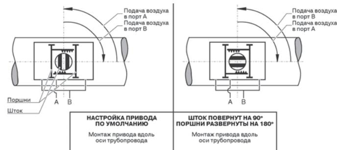
Поворачивая шток и поршни также можно изменять положение привода по отношению к арматуре и трубопроводу.
