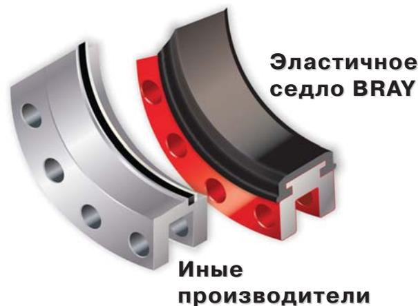
Кольцевой буртик на внешней кромке эластичного седла служит уплотнением фланцевого соединения, что позволяет обходиться без применения фланцевых уплотнительных прокладок
