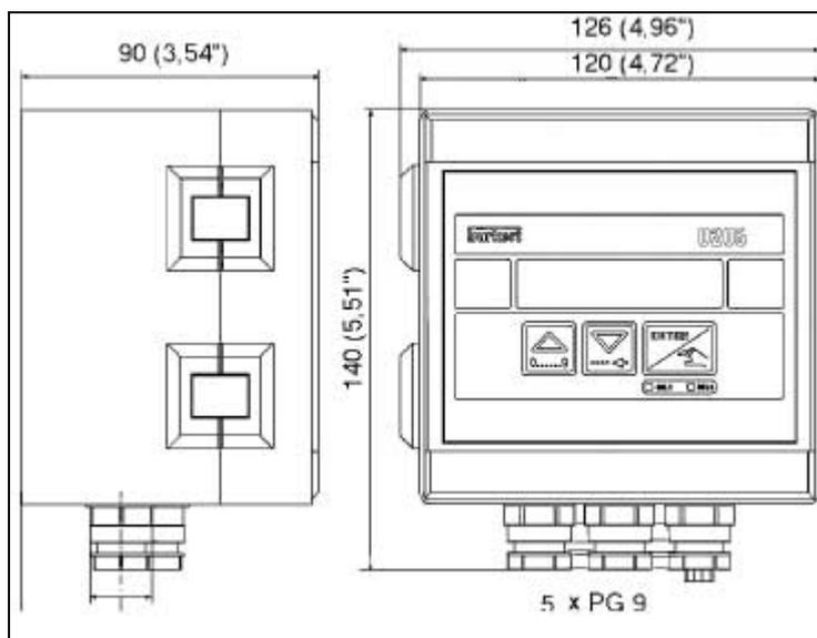
Рис. 2.5 Размеры датчика ОВП тип 8206 настенное исполнение
