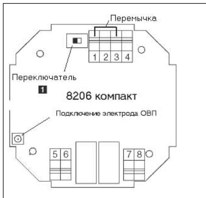
Рис. 3.6 Подключение компактного датчика 8206 с реле
