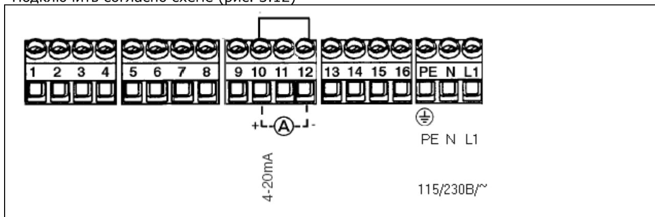
Рис. 3.12 Подключение настенного датчика 8206 – 115/230 В/50 без реле
