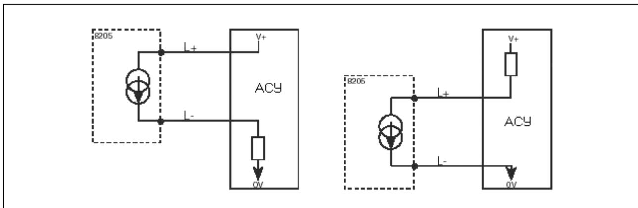
Рис. 3.7 Подсоединение выходного сигнала 4-20 мА к АСУ
