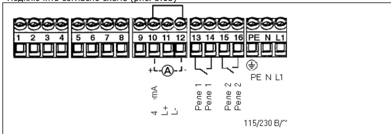
Рис. 3.13 Подключение настенного датчика 8206 – 115/230 В/50 с реле
