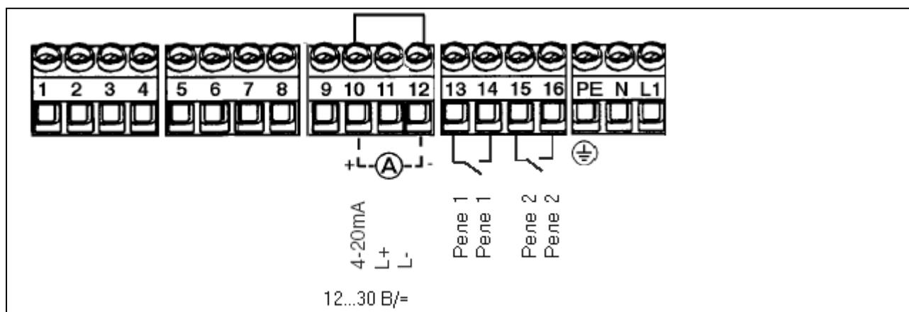
Рис. 3.11 Подключение настенного датчика 8206 – 12...30 В/= с реле
