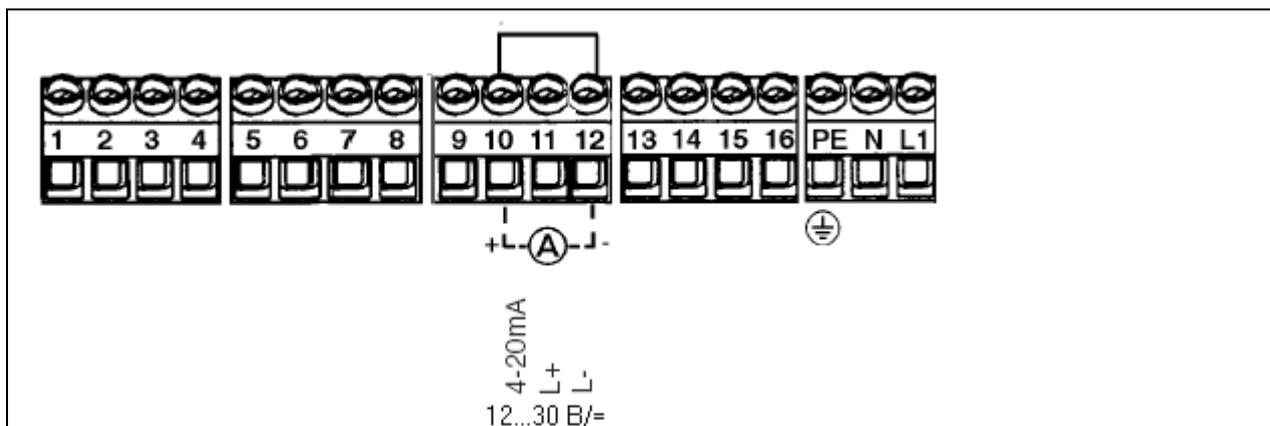
3.10 Подключение настенного датчика 12-30 В/= без реле
