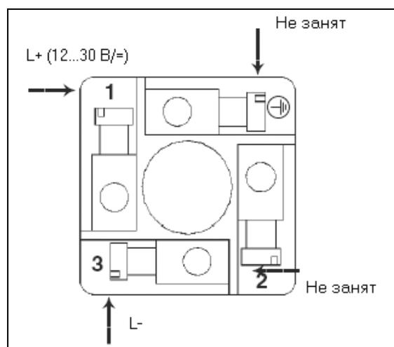
Рис. 3.5 Установка датчика ОВП 8206 в настенном исполнении
