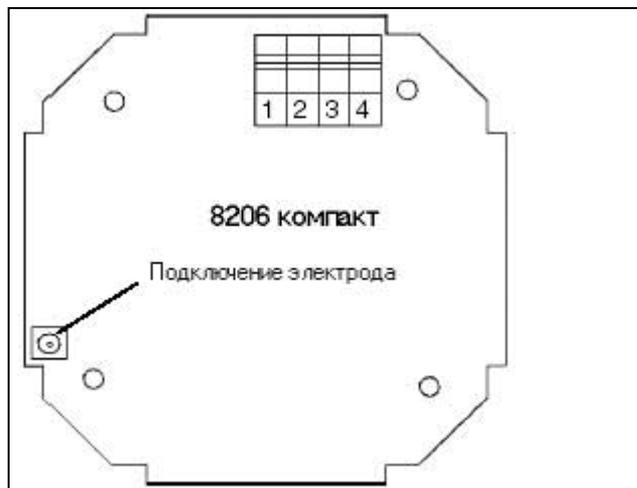
Рис. 3.6 Подключение компактного датчика ОВП 8206 без реле
