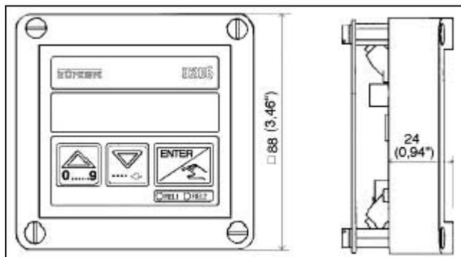
Рис. 2.4 Размеры датчика ОВП тип 8206 панельное исполнение
