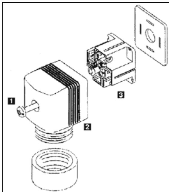
Рис. 3.4 Кабельный разъем тип 2508 стандарта DIN 43 650 A
