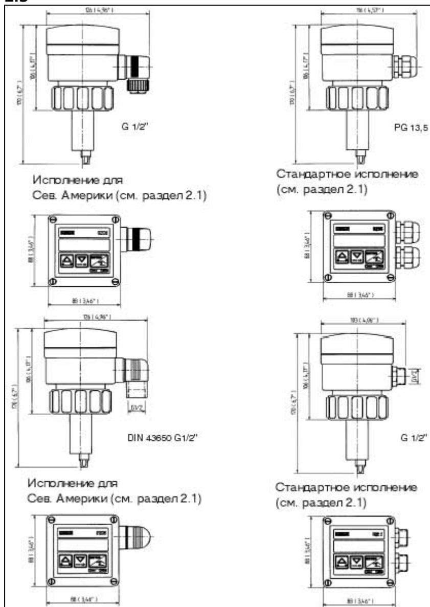
Рис. 2.3 Размеры датчика ОВП тип 8206 компактное исполнение
