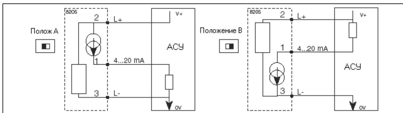
Рис. 3.9. Подключение датчика 8206 к АСУ
