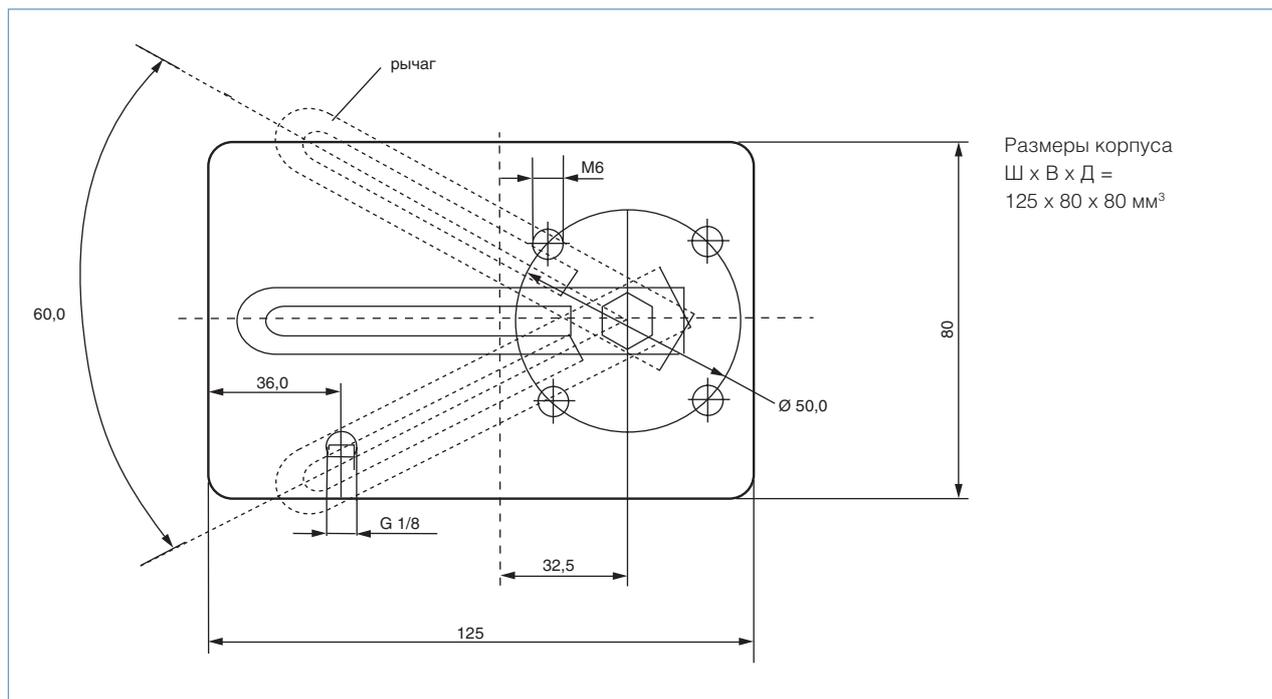
Монтажная плита по стандарту NAMUR (обратная сторона) позиционера со встроенной системой измерения перемещений. Рычаг (только у мембранных приводов) служит для преобразования подъема во вращение (0 ... 60°). У поворотных приводов вращение (0 ... 90°) снимается на приводном валу при помощи адаптера.
