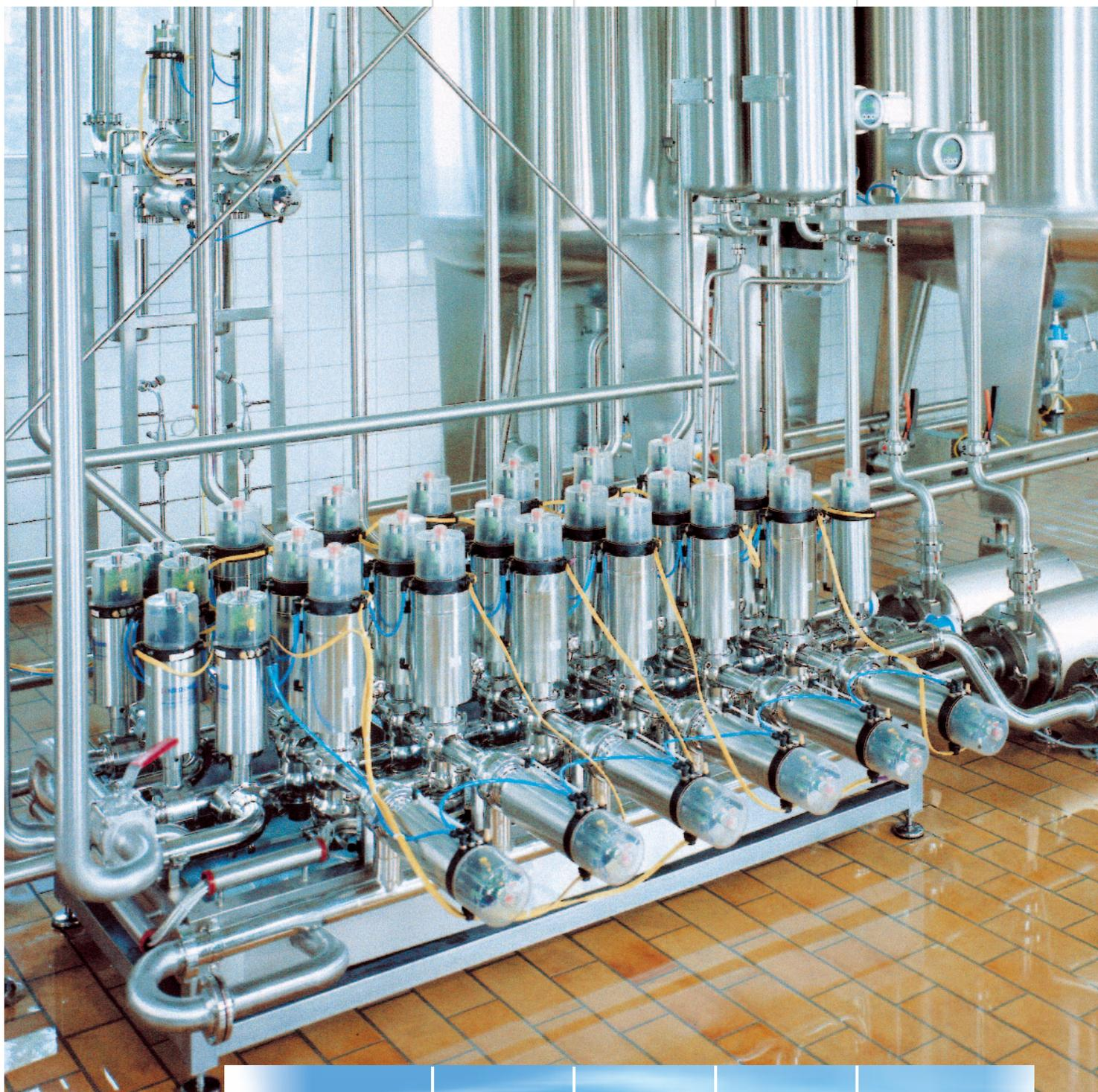
▲ Клапанная гребенка построенная на двух-седельных клапанах с управлением по шине ASI-Bus, изготовленная для использования в фармацевтической промышленности.
