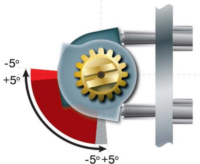
Для регулирования хода привода в более широких пределах (+/-15°) необходима установка внешних ограничителей хода.
